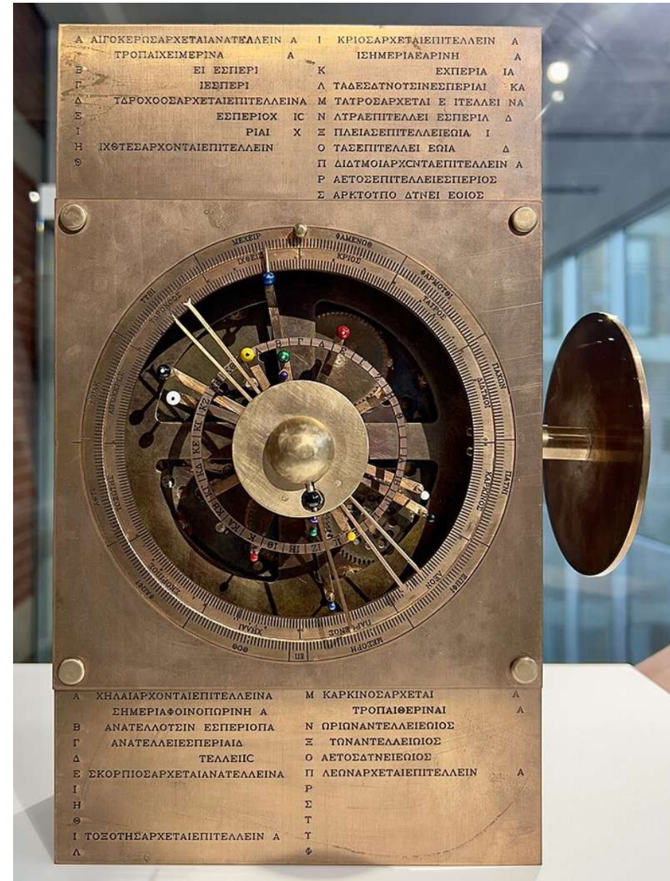
Reconstrucción que muestra cómo pudo ser el mecanismo de Anticitera. Fuente: National Geographic.
