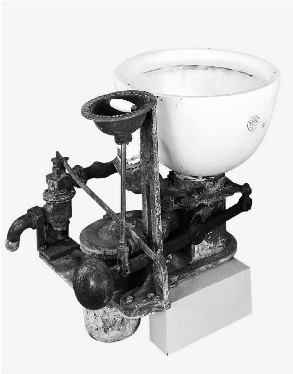
Fotografía de inodoro de 1880 con el sistema de tapón con flotador ideado por Joseph Bramah. Fuente: National Geographic.
